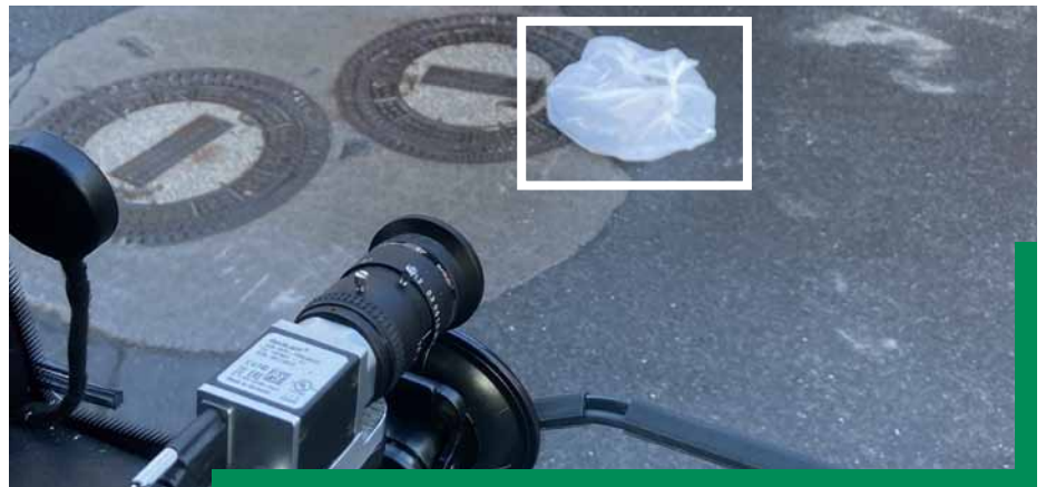
Die DATAFLEET-Kamera erfasst illegale Abfälle und übermittelt diese mit GPS-Standort an die Straßenreinigung.
