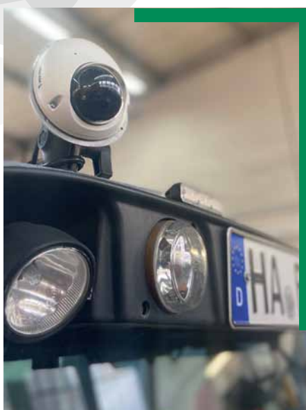
Die kleine Kamera an der Kehrmaschine erfasst Abfälle und überträgt sie ins System.
